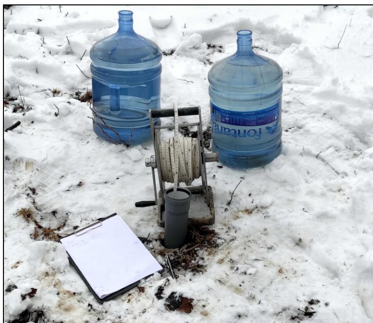
Obrázek 2. Realizace vsakovací zkoušky na sondě VS-1
